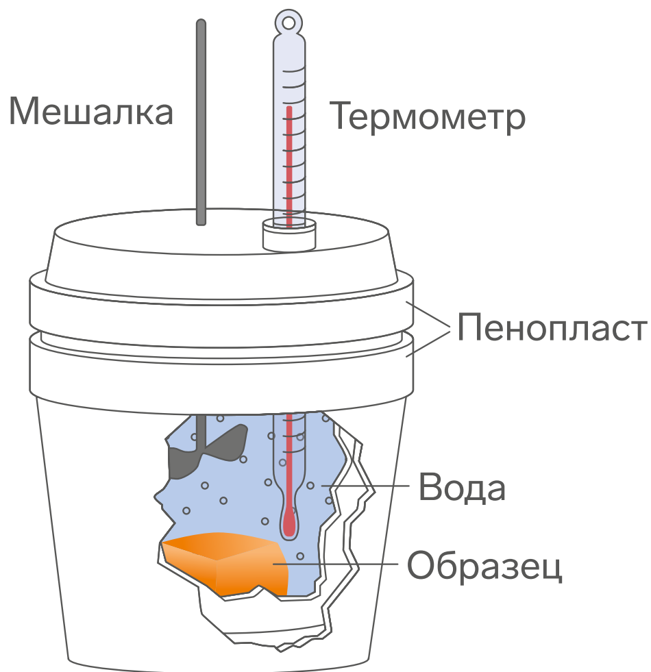
Рис. 1 Схематическое изображения 'coffee-cup'-калориметра, приведенное в работе Фибрианти и соавторов [10.1088/1742-6596/1157/4/042042].
